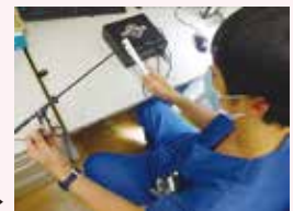
▲手術で使用する鉗子 鉗子の点検（通電チェック）▶
